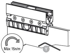
• Colocar la otra parte de la mordaza y los pernos para después apretar con llave allen de 4mm.
